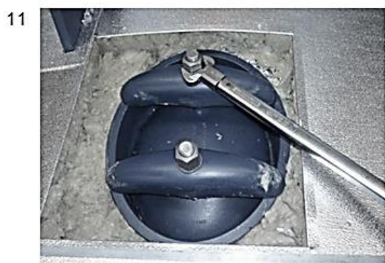
Рисунок 1: Удаление крепления для транспортировки
